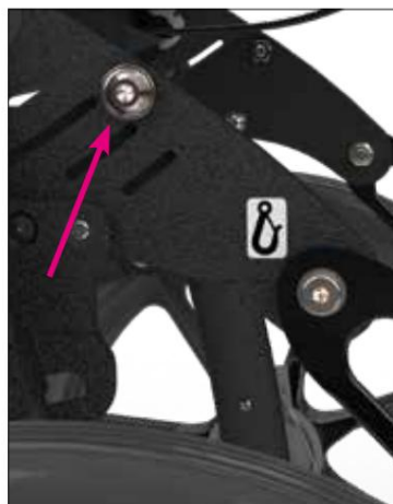
Puntos de fijación traseros según ISO 7176-19 para cinturón de regazo
